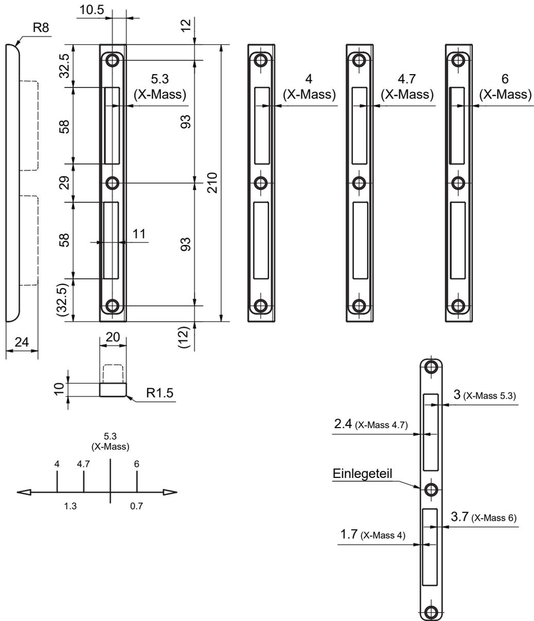
16620 - Kappenschliessblech mit 4-fach verstellbarem Einlegeteil
